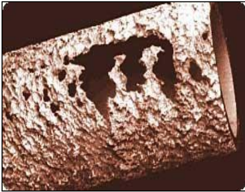
Gambar 2.9 Korosi General atau Uniform
